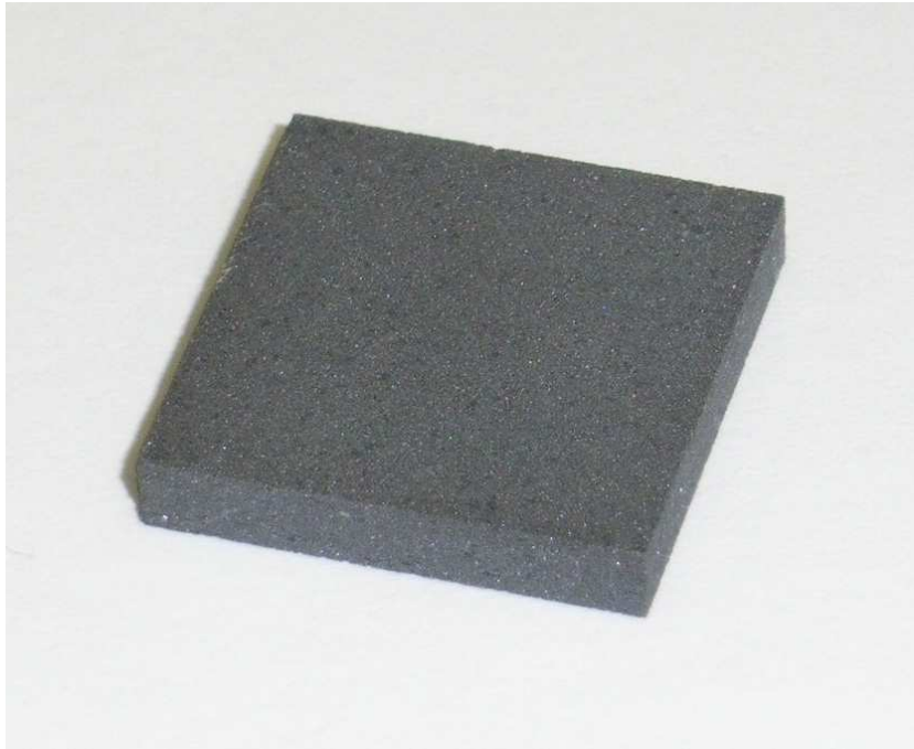
Abbildung C.1: Die Fotografie zeigt den verwendeten Bor-Absorber.
