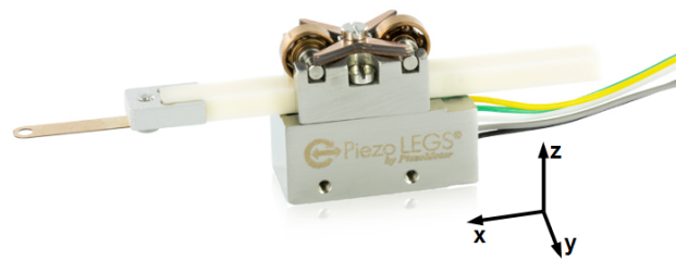
Abb. 2.2: Linearer Piezomotor Piezo LEGS ® Linear 6N LL10. [Pie16a]
