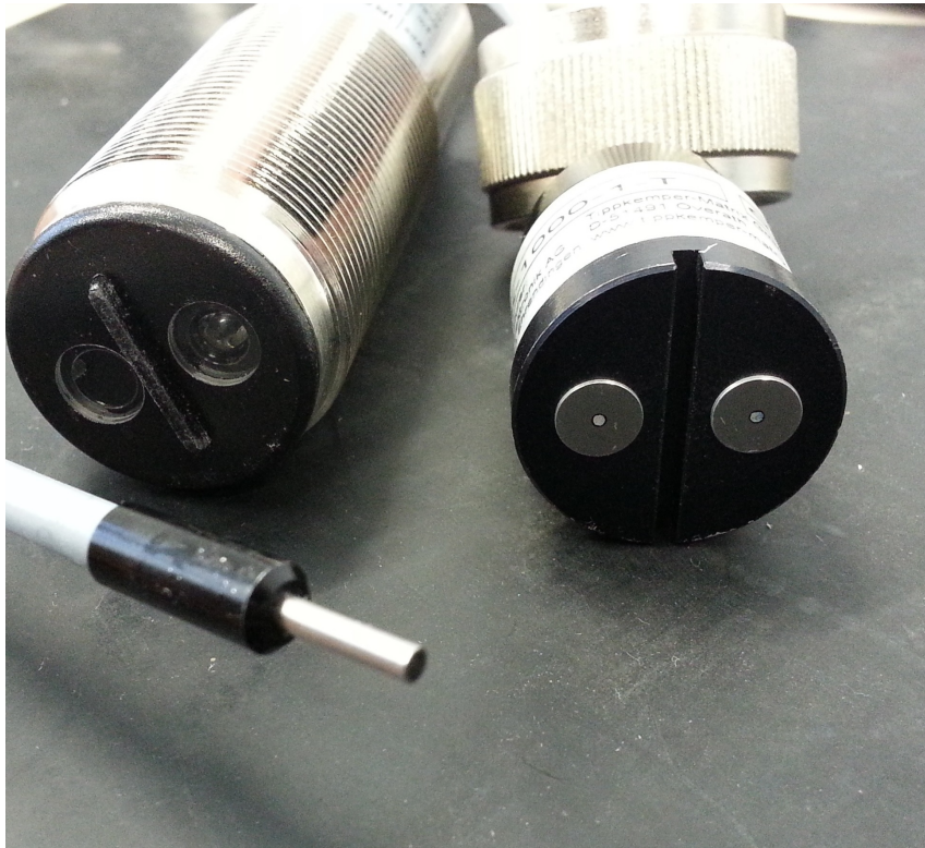
Abb. 3.5: Faseroptischer Lichttaser URS-U-2LA der Firma Tippkemper. Im Bild links hinten zu sehen ist der aktive Teil mit LED und Photodiode. Gut zu sehen ist das schwarz abgeklebte Fenster der Photodiode. Dieses dient zur Absorption von nicht-infrarotem Licht, zwecks Rauschunterdrückung. Auf der rechten Seite ist der Anschluss des Lichtwellenleiters zu sehen, im Vordergrund der hierzu gehörige Tastkopf mit 1 mm Radius. Der Lichtwellenleiter selbst ist im Bild größtenteils nicht zu sehen.
